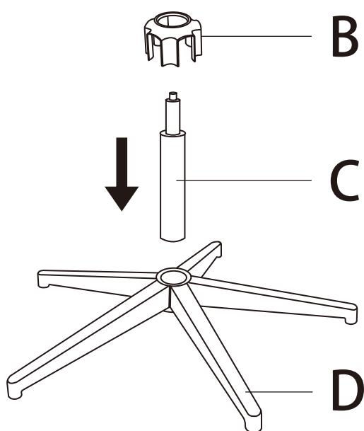
(1) 部品はD(脚部)の真ん中の穴に、矢印の向き(下向き)に従って、部品C(ガスシリンダー)を差し込んでください。差し込んだ部品C(ガスシリンダー)の上に、部品B(カバー)をかぶせてください。
