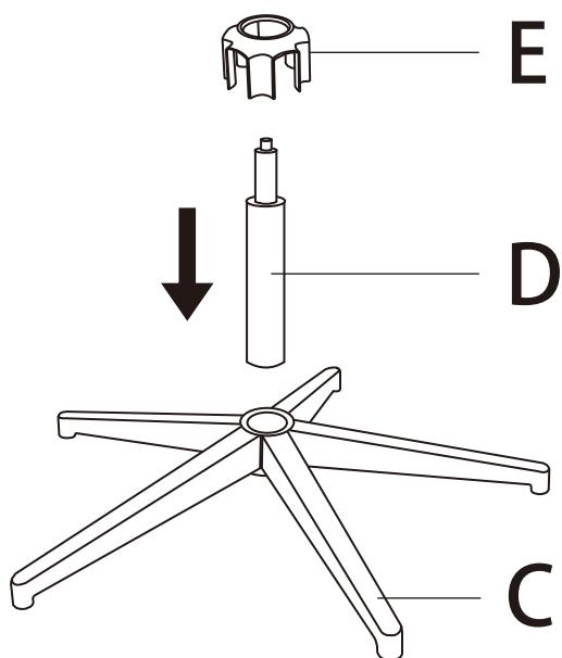
(1) 部品はC(脚部)の真ん中の穴に、矢印の向き(下向き)に従って、部品D(ガスシリンダー)を差し込んでください。差し込んだ部品D(ガスシリンダー)の上に、部品E(カバー)をかぶせてください。
