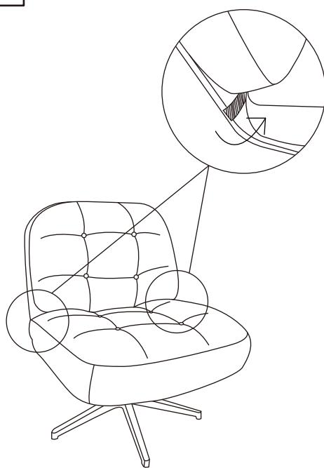
(6) 座面と背もたれの接続部分の両サイドにもマジックテープがありますので、背もたれの生地を隙間に入れ、貼り合わせて固定してください。
