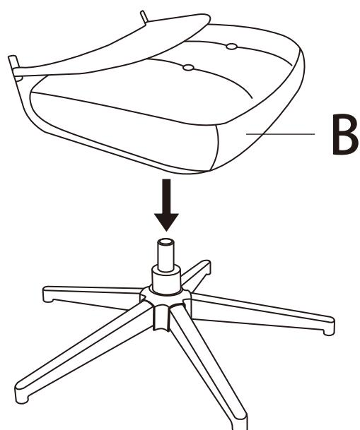
(2) ステップ1で組み立てた脚部のガスシリンダーの先端に、矢印の向き(下向き)に従って、部品B(座面)の裏側にある穴を上から差し込んでください。
